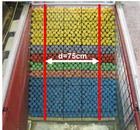
Figura 4. Manto principal del modelo de dique en talud con cubípodos de hormigón ( D_n=3.85cm ).
