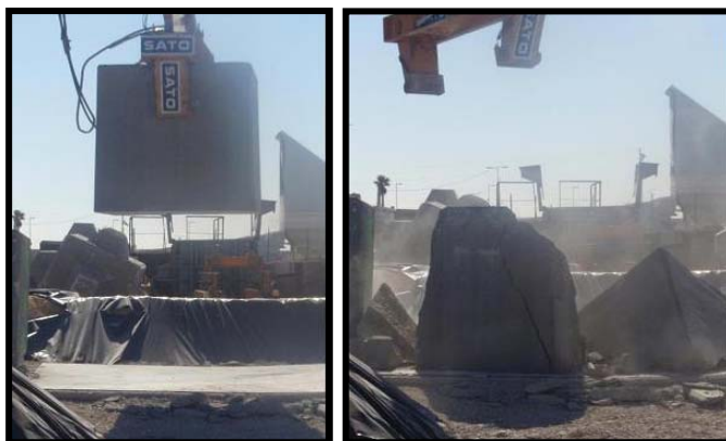
Figura 12. Caída libre de martillo del bloque cúbico desde h=2.0 metros (rotura a la 1ª).
