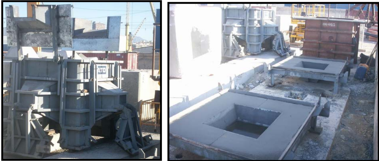
Figura 6. Elemento superior articulado y bases del encofrado del Cubípodo.
