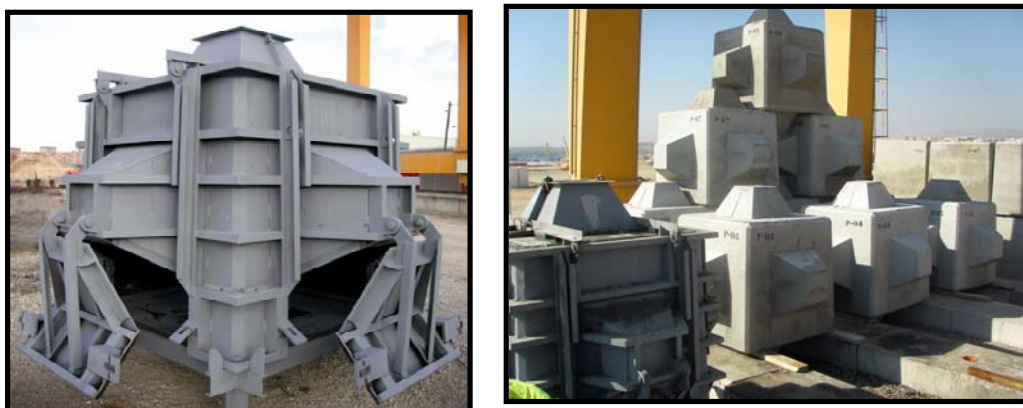
Figura 9. Encofrado y almacenamiento de cubípodos.
