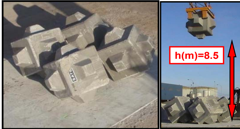
Figura 14. Caída libre extrema de martillo del Cubípodo P-04 desde h=8.5 metros.
