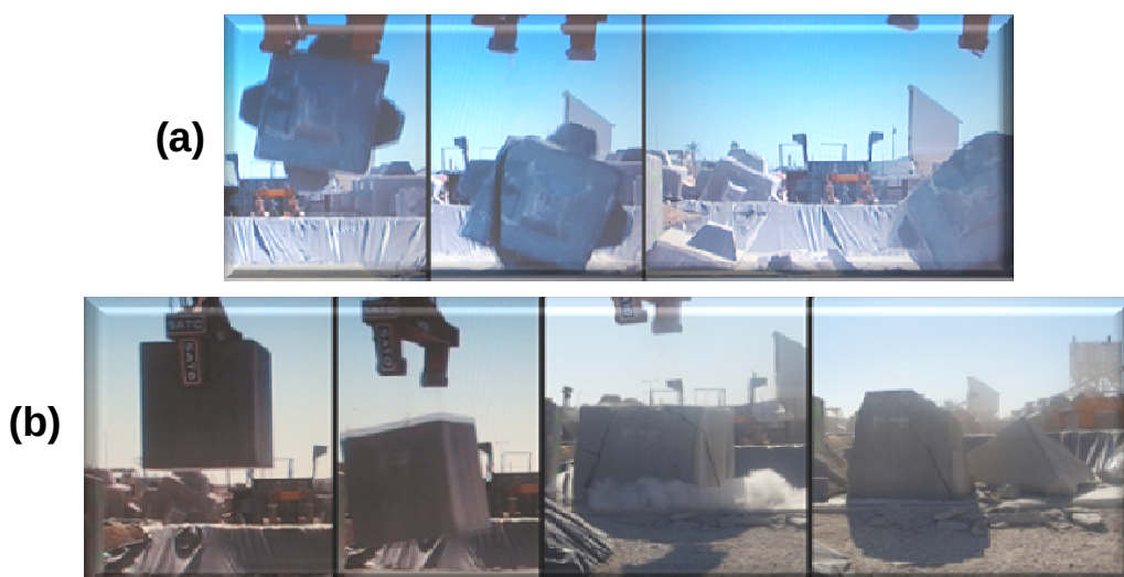
Figura 5. Caída libre de martillo desde dos metros de altura que provoca rotura del prototipo: (a) sexta caída del Cubípodo y (b) primera caída del bloque cúbico.
