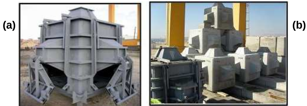
Figura 2. (a) Encofrado del Cubípodo y (b) zona de almacenamiento de prototipos.
