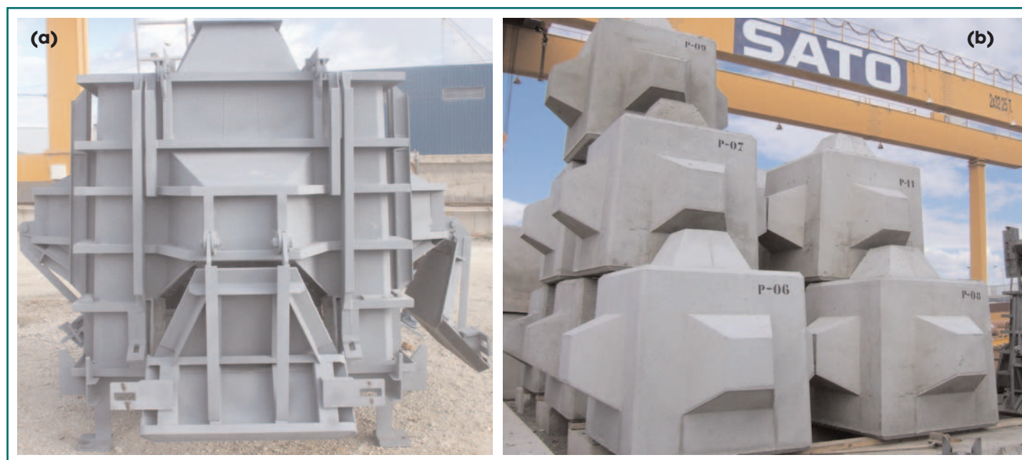
Fig. 3. Cubípodo: (a) encofrado y (b) acopio de prototipos ( W(t)=16 ) para los ensayos de caída.
