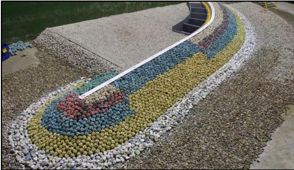
Figura 9. Modelo 3D ensayado en el CEPYC, con manto bicapa de Cubípodos de W[t]=6 en tronco y morro, del dique de San Andrés (Puerto de Málaga).
