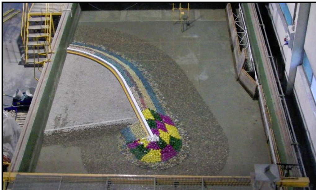
Figura 8. Modelo 3D ensayado en el CEPYC, con manto bicapa de Cubípodos de W[t]=6 en tronco y de W[t]=15 en morro, del dique de San Andrés (Puerto de Málaga).
