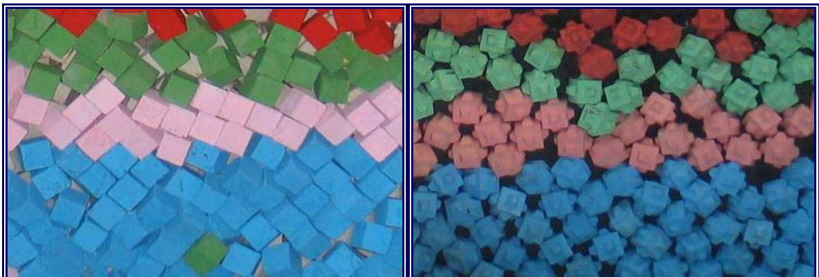
Figura 3. Adoquinamiento natural de bloques cúbicos y aleatoriedad natural de cubípodos.
