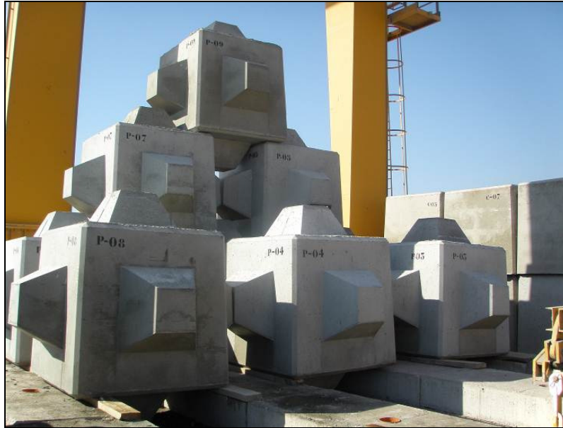
Figura 7. Acopio en disposición abierta de cubípodos y de cubos en parque.
