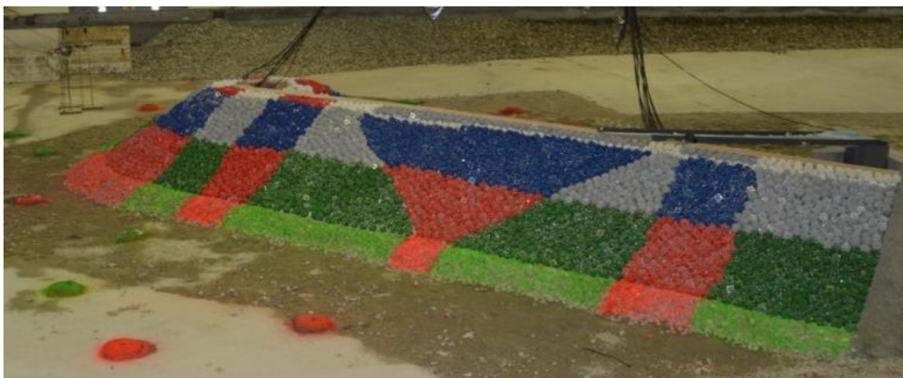
Figura 8. Modelo I “Morro” con la transición monocapa-bicapa de Cubípodos de 24 t.
