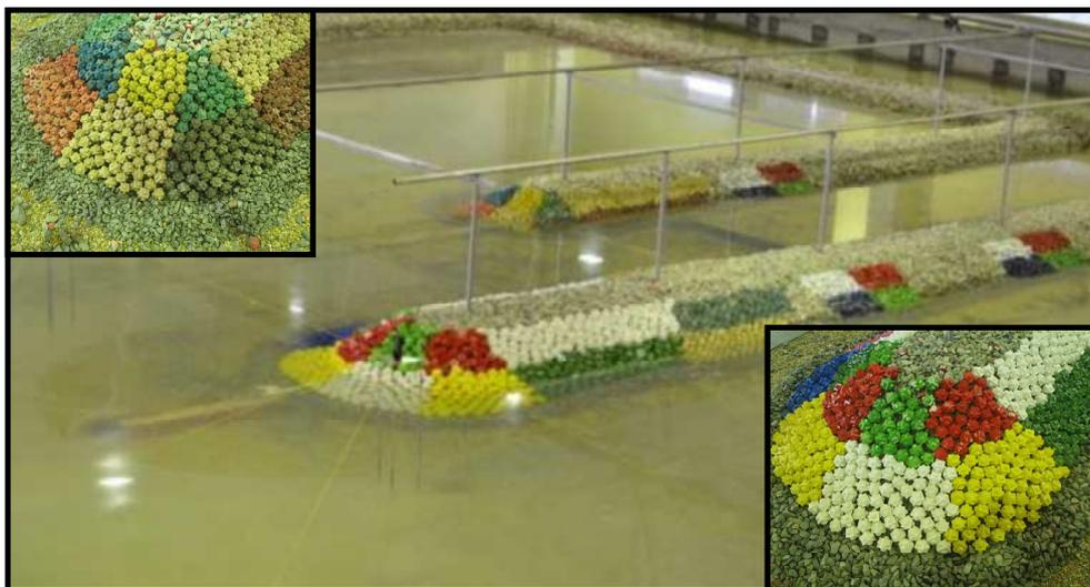
Figura 3. Tanque de oleaje 3D y modelo a escala 1/45 tras el ataque del oleaje de diseño.
