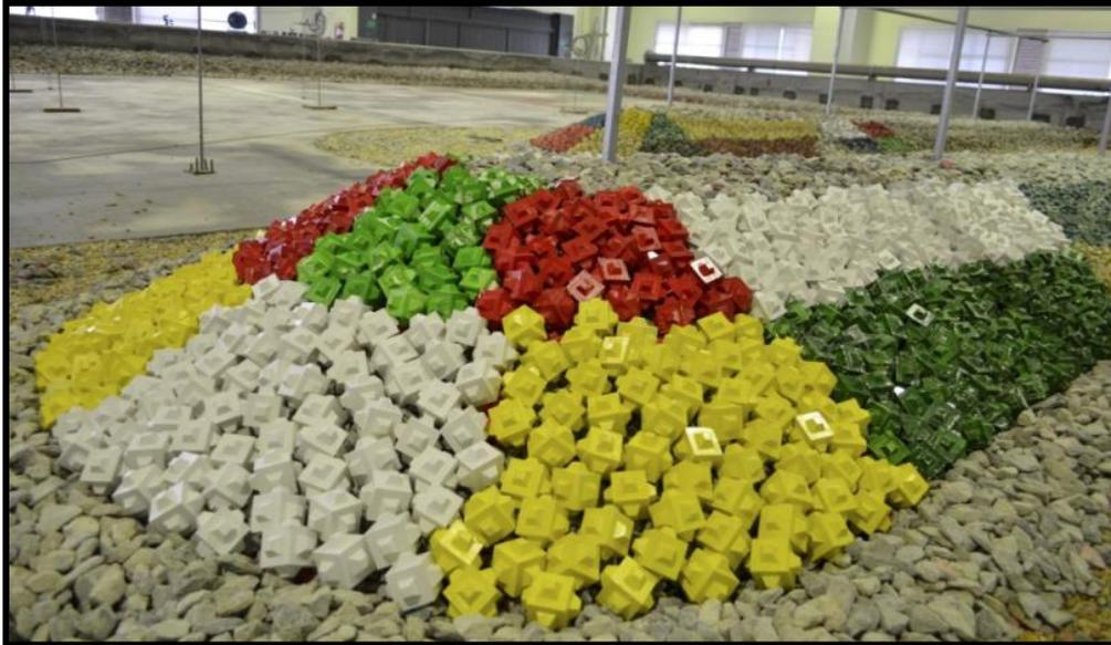
Figura 5. Vista del modelo monocapa de Cubípodos (Solución variante).
