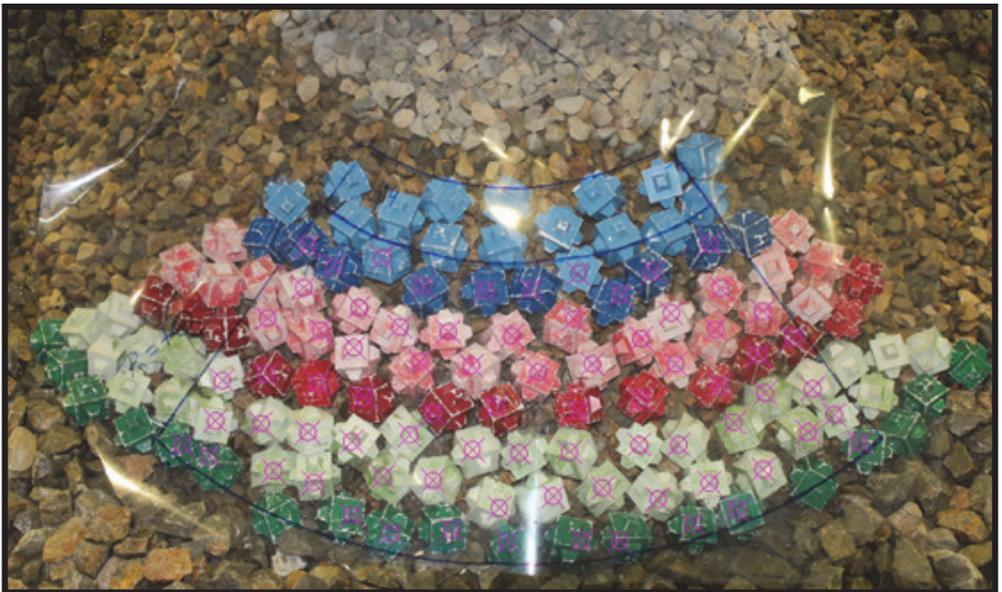
Figura 6.10 Área de referencia para calcular la porosidad del manto en el morro.
