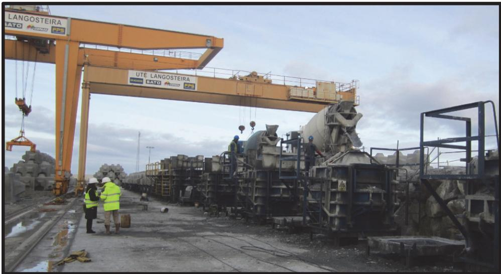
**Figura 5.5 Encofrados y línea de producción de Cubípodos de 25t (10.6 m<sup>3</sup>).**
