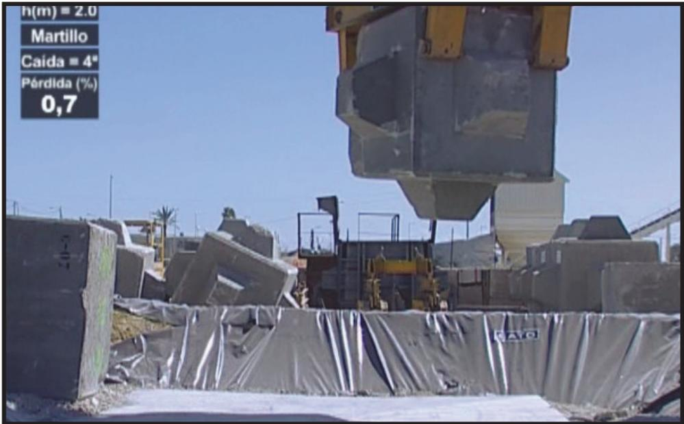
**Figura 4.2 Cubípedo® sobre plataforma de caída rígida (5.0x5.0x1.15 m).**
