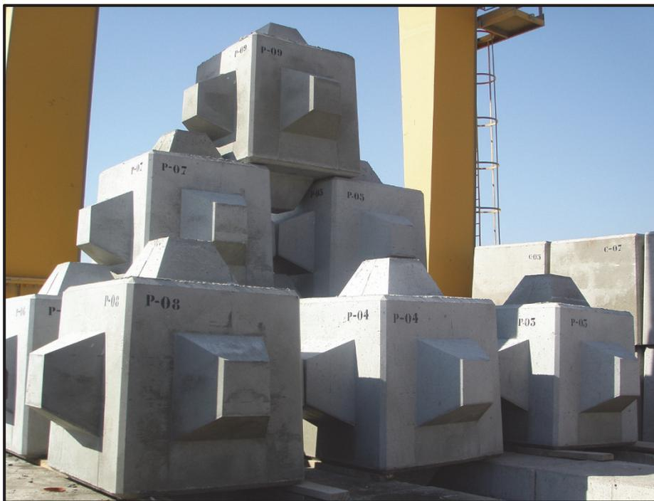
**Figura 1.2** Cubípodos de 16t y bloques cúbicos de 15t en el Puerto de Alicante.
