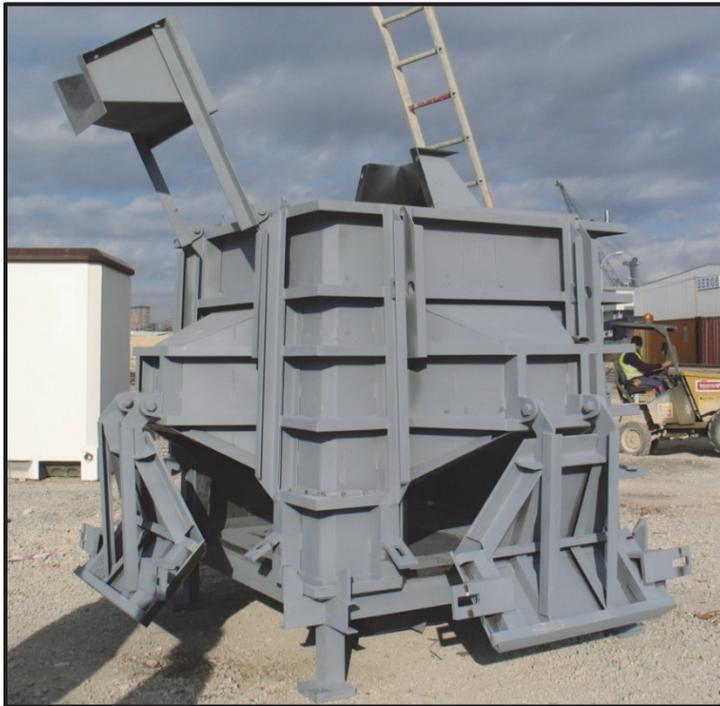
**Figura 1.7** Encofrado SATO para fabricar Cubípodos hasta  $7 \text{ m}^3$ .
