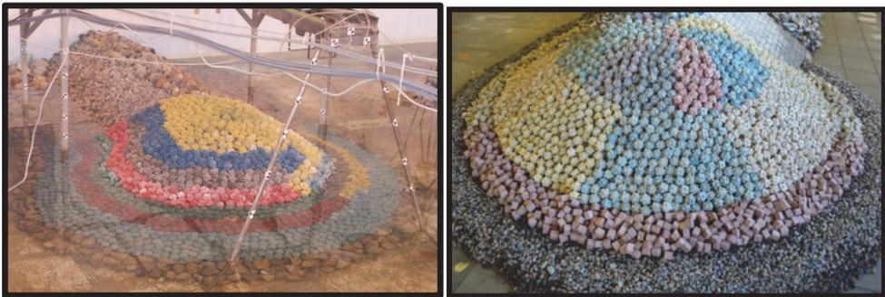
Figura 2.5 Modelos 3D de morros protegidos con bicapa de Cubípodos.
